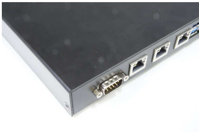
D-SUBコネクタ 取り付けねじを止める
