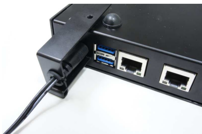
止め金具Bをスライドさせて止め金具A・電源コードに入れる
